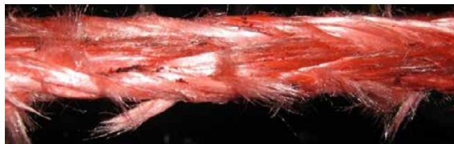
Image 1: Exemple de formation de franges. [Jakob AG / Uni Stuttgart]
