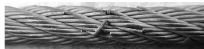
Illustration 4 : fil en saillie, qui doit être enlevé avec une pince en le pliant plusieurs fois
