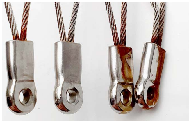
Illustration 1: Exemple d'image de la corrosion de surface sur le bord inférieur du filet lors d'un essai en laboratoire [Source : K-Labor].
