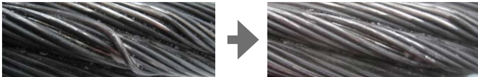
Illustration 5 : Les fils qui font saillie doivent être enlevés en les pliant d'avant en arrière
